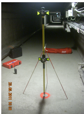
Figura 11: Asta doppio prisma da 62 mm
